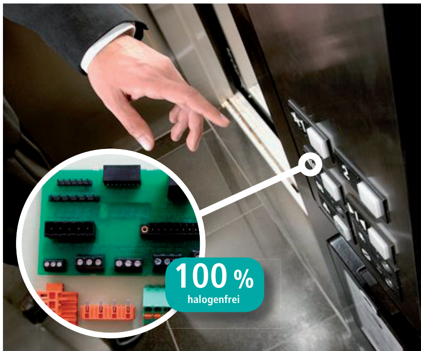
Die „grüne“ Stiftleiste aus Vectra® LCP E471i ist in verschiedenen Farben realisierbar.
